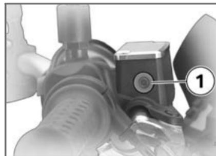
**!** Bei zu wenig Bremsflüssigkeit im Bremsflüssigkeitsbehälter kann Luft ins Bremssystem
