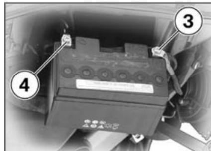
**!** Falsche Trennreihenfolge erhöht das Kurzschlussrisiko.
