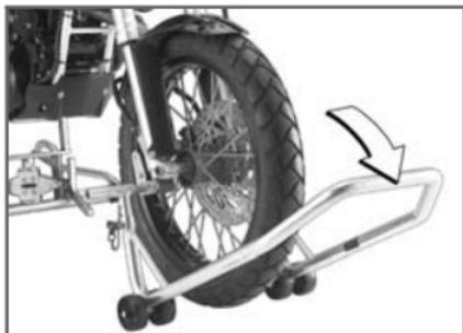
**!** Wird das Motorrad vorn zu weit angehoben, hebt der Hilfsständer vom Boden ab und das Motorrad kann zur Seite kippen.
