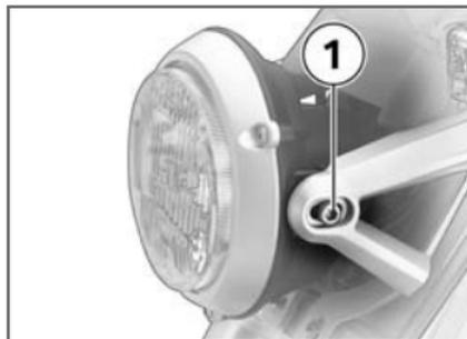
Über die Schrauben **1** links und rechts kann die Scheinwerferhöhe eingestellt werden. Um eine korrekte Einstellung sicherzustellen, sollte sie von einer Fachwerkstatt durchgeführt werden, am besten von einem BMW Motorrad Partner.
